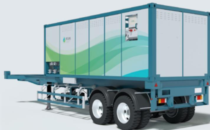
Модуль редуцирования газа представляет собой готовое транспортное средство, предназначенное для транспортирования по дороге общего пользования и обеспечения газификации потребителей посредством снижения давления компримированного природного газа с давления 25,0 МПа до давления в потребительской сети (0,3 ÷ 1,2 МПа) методом дросселирования.
