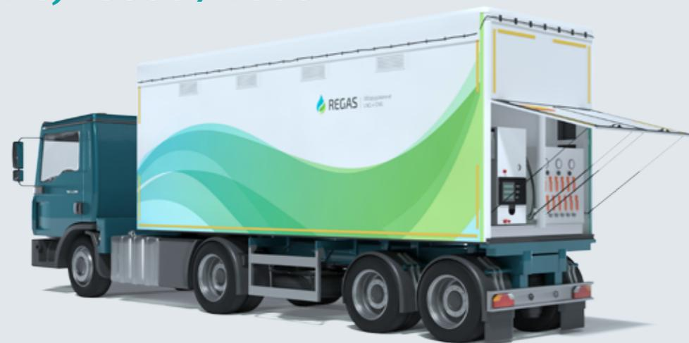
ПАГЗ предназначен для транспортировки компримированного природного газа (КПГ) и заправки от него автомобилей, использующих природный газ как моторное топливо.
