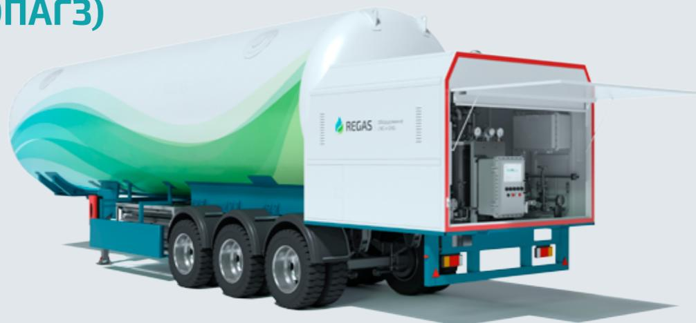
КриОПАГЗ предназначен для приема СПГ на объекте производства его транспортирования по автомобильным дорогам общего пользования и заправки СПГ в криогенные баки транспортных средств.
