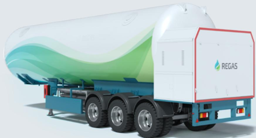
Криогенная полуприцеп-цистерна предназначена для приема СПГ на объекте производства или терминале СПГ, его временного хранения и транспортирования автомобильным транспортом по дорогам общего пользования.
